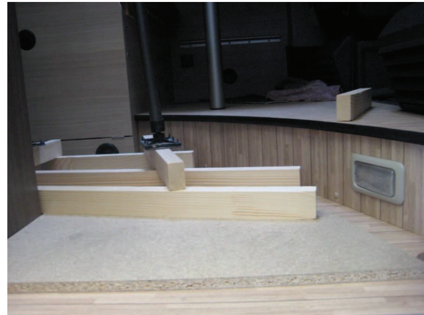
Am Innenboden mit Holzplatten und Holzleisten eine Verstärkung aufbauen, damit der Boden sich nicht wellig wird.
