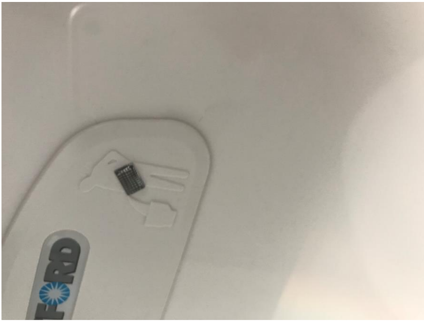
Spannungsriss rund um das Fordlogo am hinteren Teil der Toilette.
