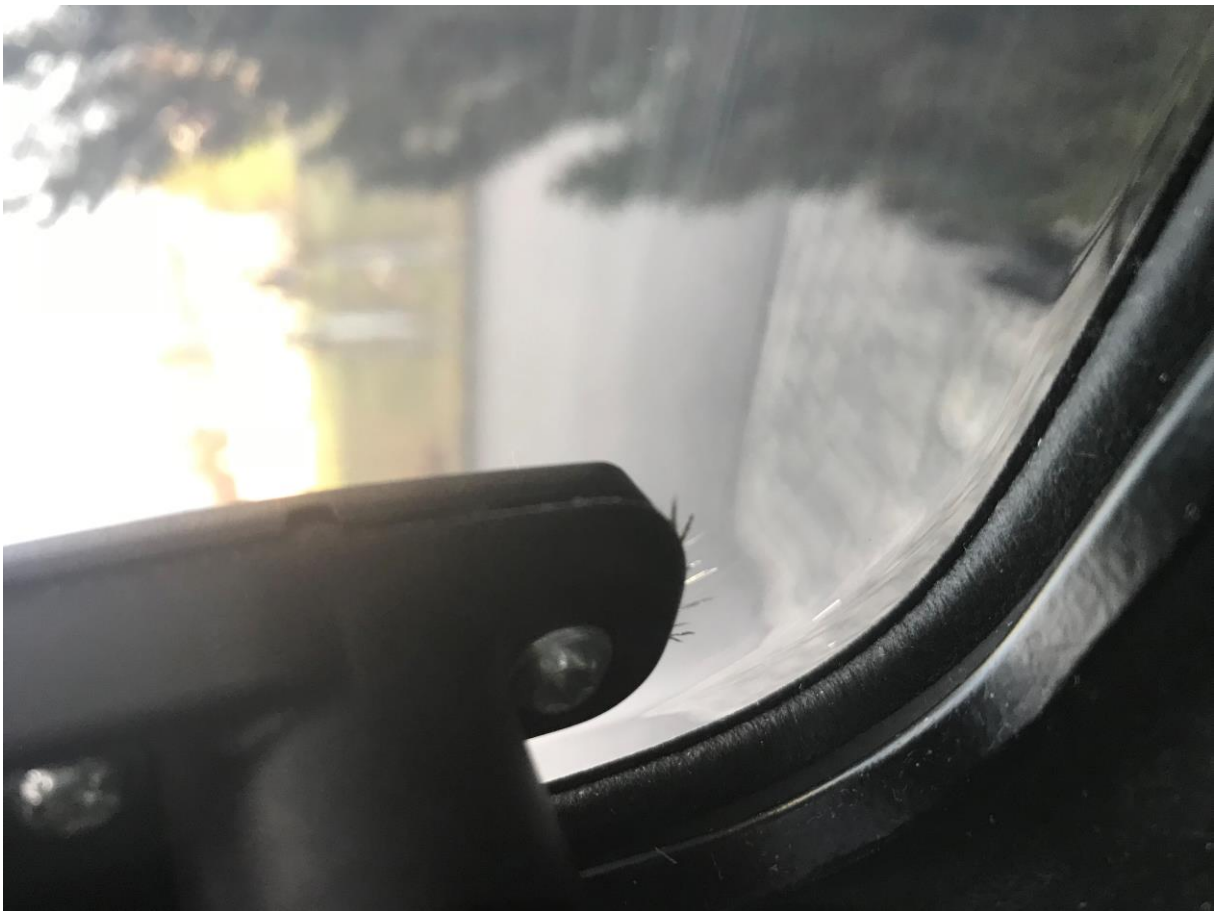
Fenster hinten Links und Rechts, Spannungsrisse bei Fensteraussteller. (Fenster neben Bett)
